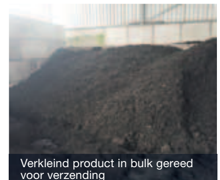
Verkleind product, gereed voor verdere recycling in asfalt of bitumen dakbanen
